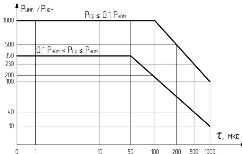
Для резисторов с номинальным сопротивлением до 100 Ом включительно и резисторов мощностью 0,25 Вт допустимая перегрузка ( $q$ ) при средней мощности менее или равной  $0,1 P_{\text{номин.}}$  не должна превышать 500.
